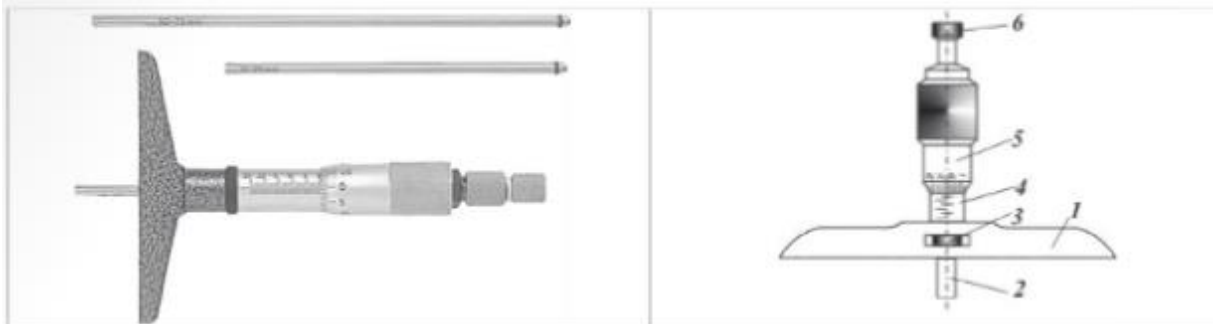
Fig. 2.14. Micrometru de adâncime: 1 – talpa micrometrului, 2 – tijă de măsurare, 3 – dispozitiv de blocare, 4 – bușă cilindrică gradată în milimetri și jumătăți de milimetru, 5 – scara gradată a tamburului, 6 – dispozitiv de limitare a forței de apăsare.
