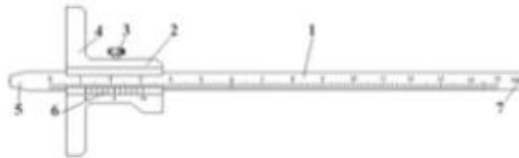
Fig. 2.4. Șubler de adâncime: 1 - riglă gradată; 2 - cursor; 3 - șurubul de fixare a cursorului; 4 - talpa cursorului; 5 - ciocul riglei; 6 - vernier; 7 - loc de marcarea
