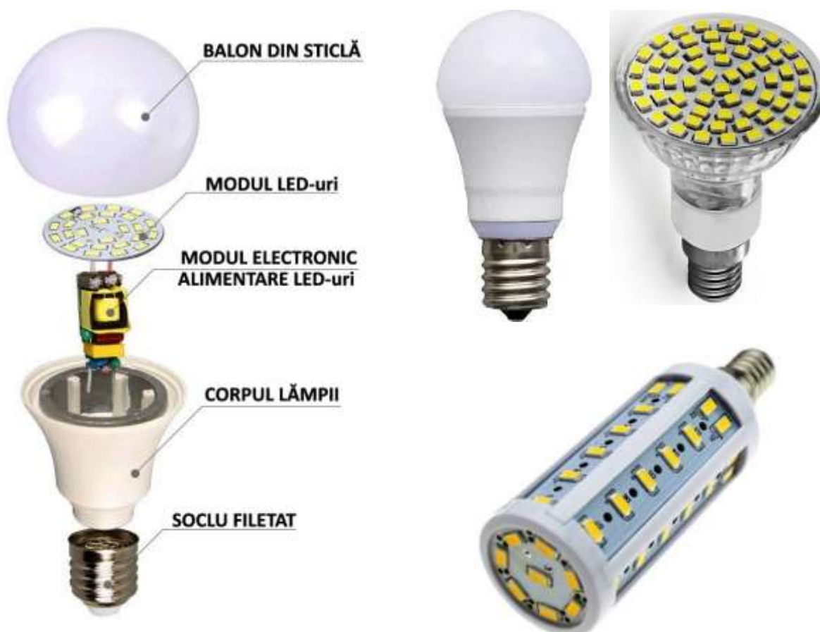
Figura 1.15 Elemente constructive lampă cu LED-uri
